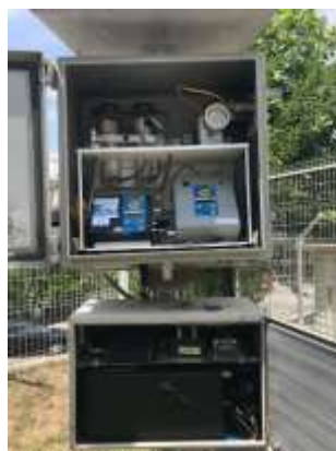
Figura 2.4 - Stație fixă de prelevare cu debit scăzut (10 l/min), marca F&J, model LV118ECNV CAS
